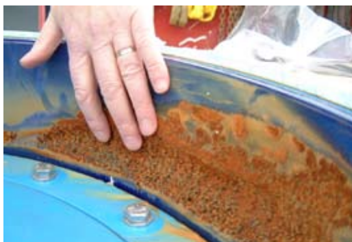
Knappt ett år gamla vridspjällventiler i mätkammarna till Helsingborg har bytts ut mot ringkolvventiler efter att de utsatts för kraftiga kavitationsskador.
