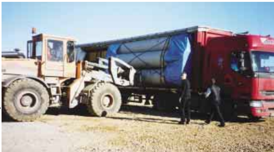
Rör (glasfiberarmerad polyester) levereras med lastbil från Tjeckien till upplag för Ringsjöledning 2.
